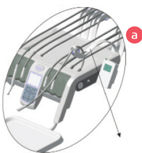
LIGADO Haste do micromotor deslocada para frente
