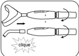
**⚠ CUIDADO:** Rosqueie a bateria no corpo e insira a ponteira de luz ou a ponteira de clareamento até escutar um som de clique e sentir o encaixe.
