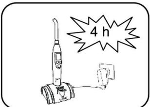
**⚠ AVISO:** Coloque o fotopolimerizador na base do carregador por pelo menos 4 horas para carregar totalmente. A primeira carga da bateria requer no mínimo 8 horas.
