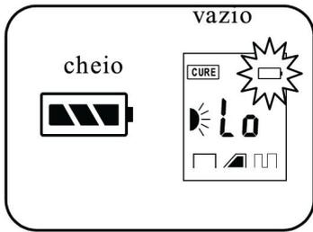
O display de LCD mostra a quantidade de carga da bateria. Se a carga estiver acabando o indicador irá piscar e o display de LCD mostrará "LO". Neste estado o bip irá tocar até o desligamento total do console.
