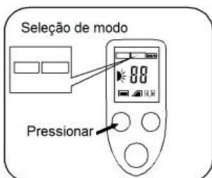
Pressione o botão “modo” para escolher o modo de trabalho. Pode-se optar pelo modo de cura de resinas (CURE) ou branqueamento (WHITEN) (modelo DUAL), segurando o botão “modo” por 5 segundos.
