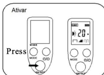
Sem nenhuma operação durante 1 minuto a iluminação da tela se desligará e após 3 minutos ele entra em modo de espera. Pressionando o botão ON/OFF, o console é ligado novamente.
