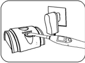
Há um medidor de luz de LED na base do carregador. Método de uso: Coloque o equipamento no modo forte e contínuo, em seguida coloque a ponta de luz exatamente no centro do medidor, depois ligue a luz e leia a potência do LED no indicador.
