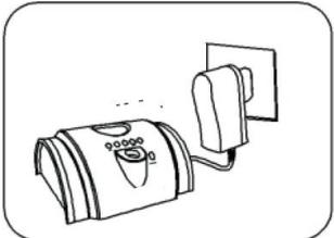
**⚠ AVISO:** Coloque a base do carregador em um lugar estável e conecte o carregador na energia. Quando colocar o fotopolimerizador (com bateria) na base do carregador, ela indicará o estado da bateria através do LED “Carga”.
