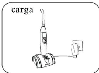
Se a carga da bateria estiver insuficiente, coloque o console no carregador. Se desejar carregar completamente a bateria é necessário aguardar pelo menos 4 horas.
