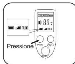
No modo de cura, pode-se optar por iluminação contínua, progressiva ou pulsante pressionando-se rapidamente o botão “modo”.
