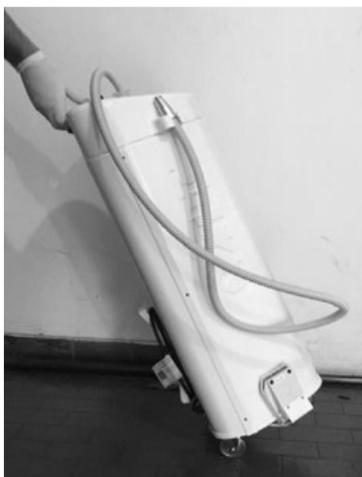
NOTA 1: Não transporte o equipamento cheio. Caso haja necessidade de transportar o equipamento em posição com inclinação maior que 10 graus (deitado no porta-malas, por exemplo), o equipamento deve estar vazio. Para tanto, realize o processo de drenagem descrito na seção “Drenagem de efluentes”.
