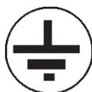
Aterramento para proteção (em vários pontos do equipamento) indica a condição de estar aterrado.
