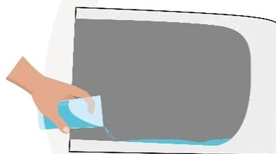
**⚠** Atenção: Não utilizar água de torneira, pois os sais minerais e cloro têm efeito oxidante sobre os metais, causando danos na câmara de esterilização e nos instrumentos que estão sendo esterilizados ou entupimento das tubulações e válvulas.
