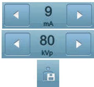
Alterações incrementais em kVp e mA podem ser feitas pressionando o lado esquerdo, direito do botão de seta. O kVp pode ser alterado em 1kVp por clique e o mA pode ser alterado em 0.5mA por clique. (O tempo de exposição não pode ser controlado) As condições de exposição alteradas podem ser salvas clicando no botão Salvar.
